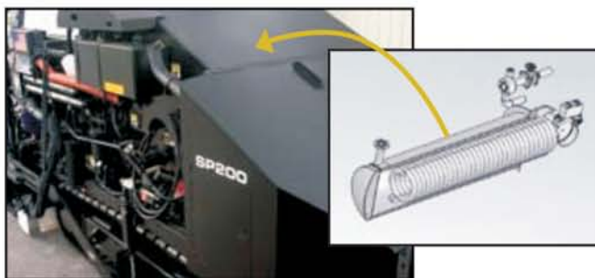
Дизельная спиральная катушка нагревателя вытянута по всей длине резервуара для равномерного нагрева.
